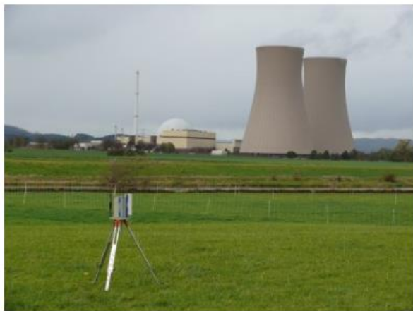
Abbildung: In-Situ Gammaskpektrometrie Messung in der Umgebung des Kernkraftwerks Grohnde.
